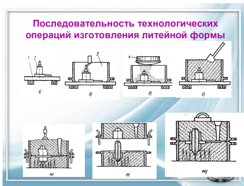
Рисунок 2 – Последовательность технологических операций изготовления литейной формы
